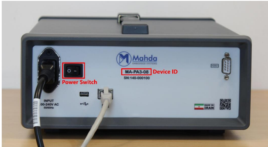
شکل ۳-۲: محل قرارگیری کلید پاور و ID دستگاه در پنل پشتی
